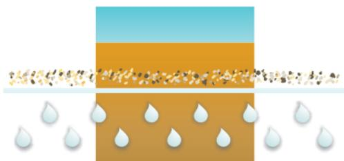
A constituição dos geotêxteis garante uma elevada área filtrante constituída por pequenos poros, permitindo assim o escoamento da água, ao mesmo tempo que os finos ficam retidos sem que ocorra colmatção.
