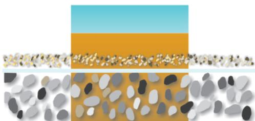
O diferente comportamento das várias camadas de materiais e a consequente separação das mesmas é solucionado pela inclusão de um geotêxtil, o qual funciona como elemento de distribuição das cargas ao mesmo tempo que a sua diminuta estrutura porosa impede a mistura entre as várias camadas.
