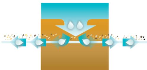
Aplicados como elementos drenantes, os geotêxteis permitem a remoção de excesso de água do solo que se processa ao longo do plano do geotêxtil, diminuindo assim as tensões hidráulicas e prolongando o tempo de vida dos sistemas drenantes ao mesmo tempo que permitem a diminuição das camadas drenantes.
