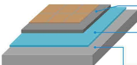
laje de compressão flutuante sobre o isolamento aos ruídos de impacto, formada por betonilha ou argamassa com espessura não inferior a 4cm ou a 6cm conforme aplicado sobre **imperimpact®** de 5mm ou de 10mm, respetivamente.
